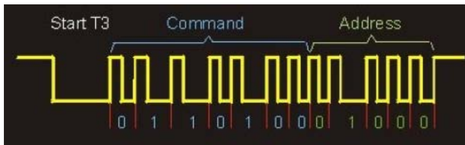
Figura 4: Tren de pulsos de un control remoto SONY
